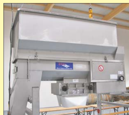
Qualitätssprung: Dank der neuen Abbeermaschine lässt sich das Traubengut sanfter und zielgerichteter verarbeiten
